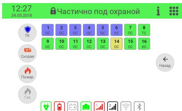
Рисунок 4. Состояние источников питания, каналов связи, датчиков, подключенных к прибору по ШР и охранных зон
